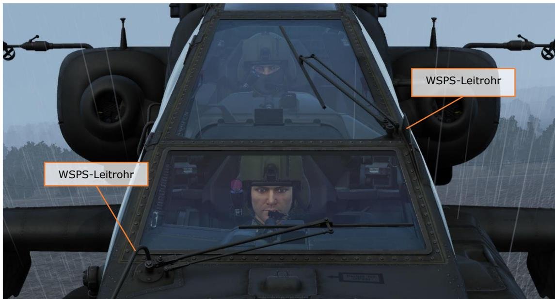
Die Kabinendächer verfügen außerdem über Scheibenwischer, die von den Besatzungsmitgliedern gesteuert werden können, und ein Anti-Beschlag-System, das durch das IPAS betrieben wird.
