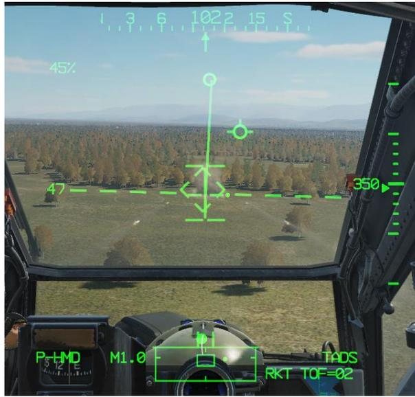
HMD-Raketeneinsatz - Ausrichtung des Raketensteuerungs-Cursors
