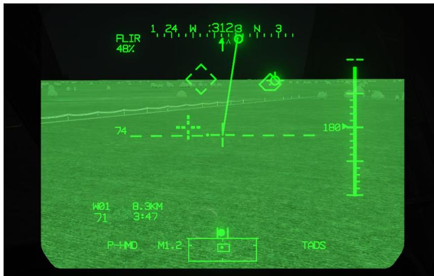
Piloten-HDU mit Flugsymbologie & Videobild des PNVS
