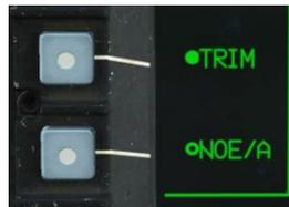
**An- / Aus-Knopf.** Das Drücken schaltet ein System ein oder aus. Ist der Kreis ausgefüllt, dann ist das System an. Ist der Kreis leer, dann ist das System aus.
