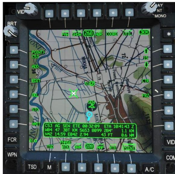
POINT-Unterseite, ADD-Menü, Manuelle Eingabe eines Navigationspunkts
