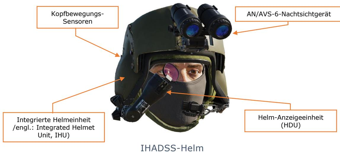
Durch das HDU sieht die Besatzung in einem 30°x40° großem Sichtfeld der Außenwelt, über das die Flugsymbolik gelegt wird, zusätzlich zu den Sensorvideos des Piloten Nachtsichtsystem (PNVS) oder Target Acquisition Designation Sight (TADS).
