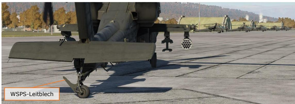
Das Spornrad ist im vollen 360°-Bewegungsbereich freilaufend. Eine federbelastete Spornradsperrung kann hydraulisch betätigt werden, um das Spornrad in Position zu halten. Die Spornradverriegelung kann über beide Kollektivhebel oder die Spornradverriegelungsdrucktasten aktiviert werden.
