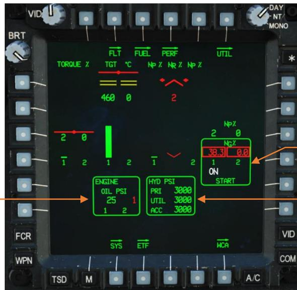
Triebwerksölddruck in PSI
