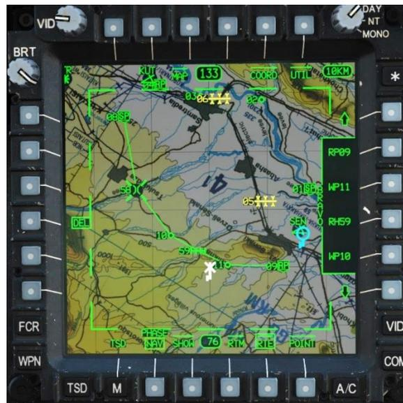
Mittels Cursor ausgewählter Punkt zum Löschen aus der existierenden Route
