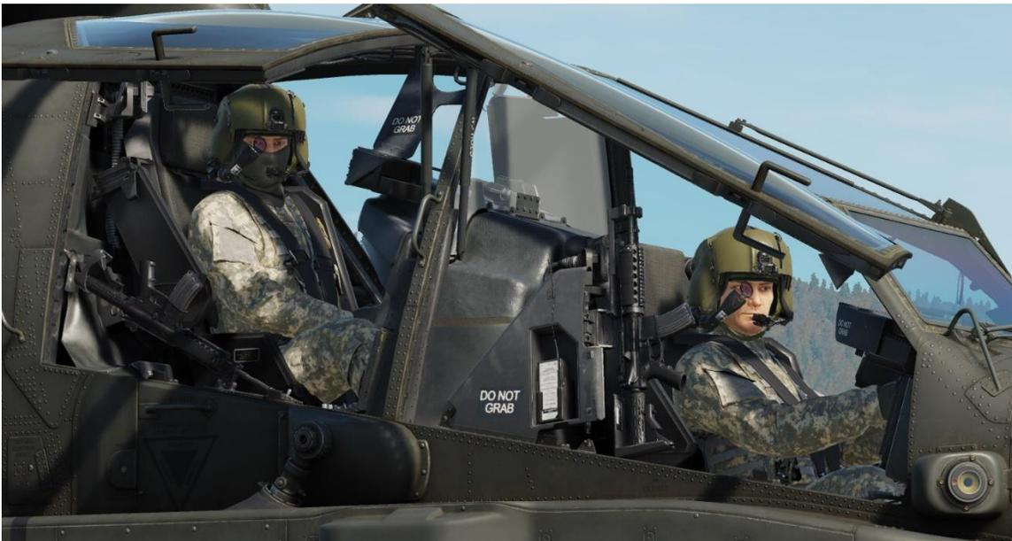
Beide Cockpithauben bestehen jeweils aus zwei beheizbaren, gläsernen Windschutzscheiben und fünf Seitenfenstern aus Acryl. Die Cockpithauben öffnen sich vor- und seitwärts für den Ein- bzw. Ausstieg und werden für den Flug verriegelt. Eine unzureichende Verriegelung wird erkannt und über die bordseitige Avionik bekanntgegeben.
