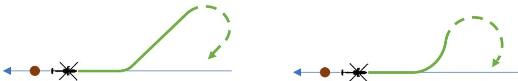
45/180 Verfahrenskurve (Linkes Bild), 80/260 Verfahrenskurve (Rechtes Bild)
