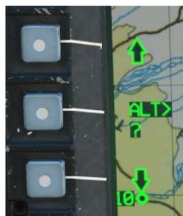
Die Aufwärts-/Abwärtspfeile ändern die Geländepunkthöhe in Schritten von 5 Fuß (schneller, wenn sie gedrückt gehalten werden). Wenn der ALT-Knopf gedrückt wird, ermöglicht es die Eingabe der Geländepunkthöhe unter Verwendung der KU.
