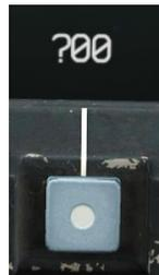
**Fehlende oder ungültige Daten.** Wird ein weißes Fragezeichen dargestellt, so bedeutet das, dass die Eingabe fehlerhaft, unvollständig oder ungültig ist.
