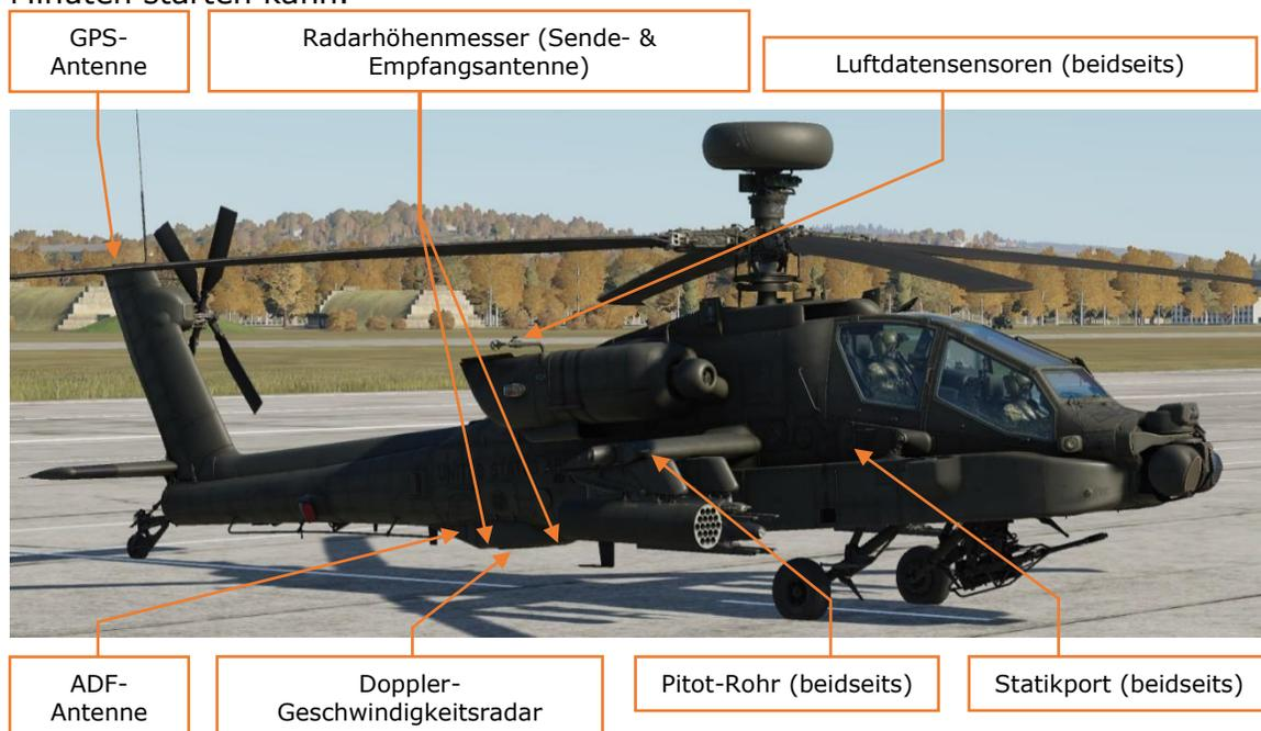
Während des Fluges empfängt der AH-64D kontinuierlich Positionsdaten von GPS-Satelliten, um die INU-Position zuverlässig zu halten und eine präzise Navigation zu ermöglichen. Als Notfallsystem ist der AH-64D mit einem AN/ARN-149 Radiokompass (engl.: Automatic Direction Finder) ausgestattet.
