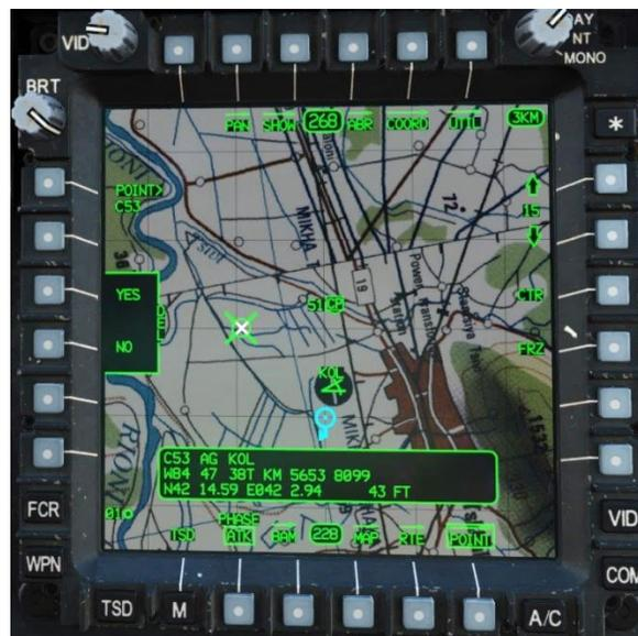
POINT-Unterseite, Bestätigung der Löschung
