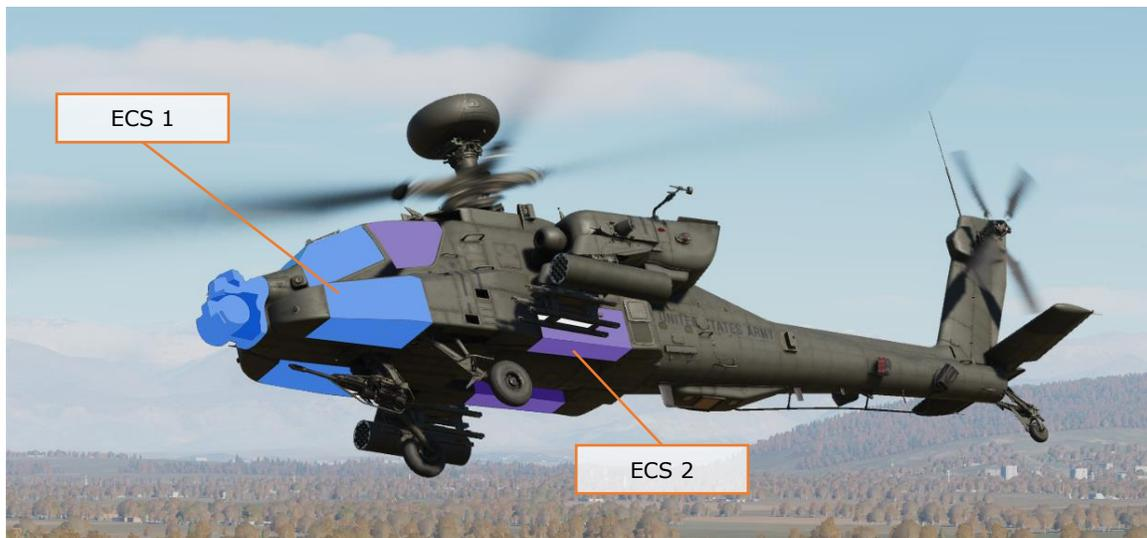
Bei einem Ausfall eines der ECS-Systeme öffnet die DCU des funktionierenden Systems automatisch ein Verbindungsventil zwischen den beiden Cockpits. Die Ventilatoren des ausgefallenen Cockpits werden abgeschaltet, und die Ventilatoren des funktionierenden Cockpits drücken gekühlte Luft in beide Cockpits.
