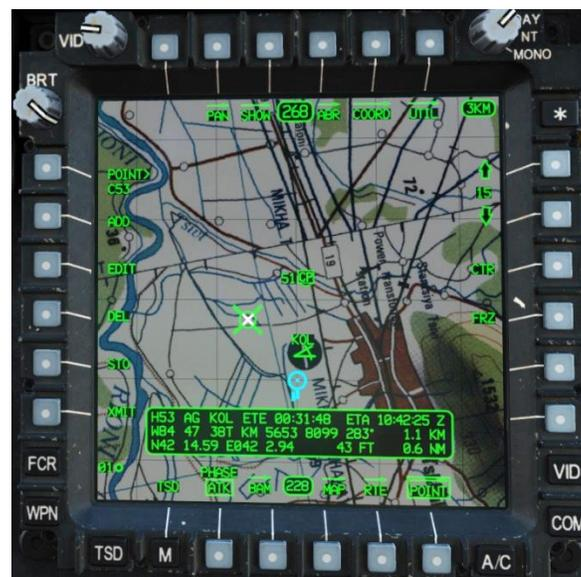
POINT-Unterseite, Punkt mit geändertem Freitext
