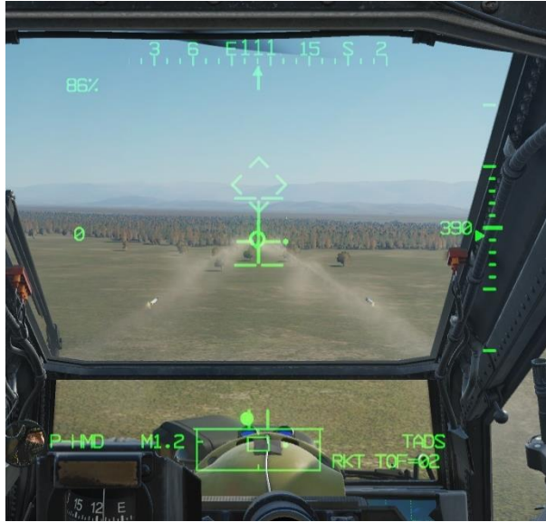
图 244. 使用 HMD 进行火箭弹攻击 - 对齐火箭弹操控光标
