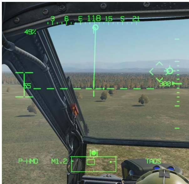
图 246. 使用 HMD 进行火箭弹攻击 - 飞行员 HMD 准星对准目标
