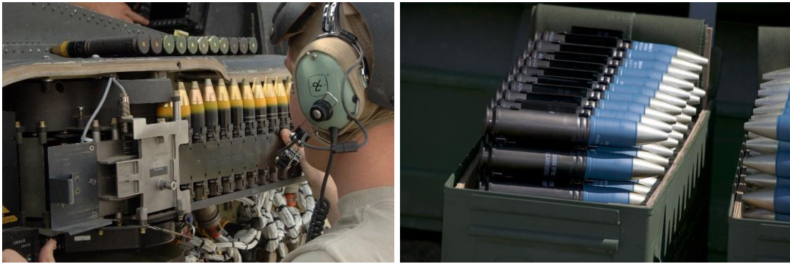
图 6. M789 HEDP（左）和 M788 TP（右）30 毫米弹药
