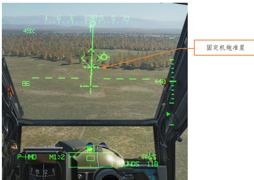
图 228. HMD 固定机炮攻击 - 瞄准目标
