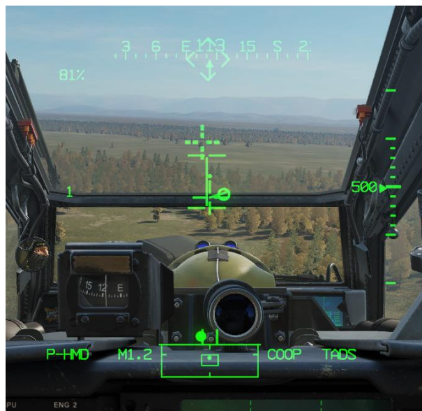
图 238. 合作模式火箭弹直接攻击 - 飞行员 HMD 标志
