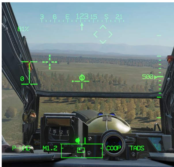
图 236. 合作模式火箭弹直接攻击 - 飞行员 HMD 标志
