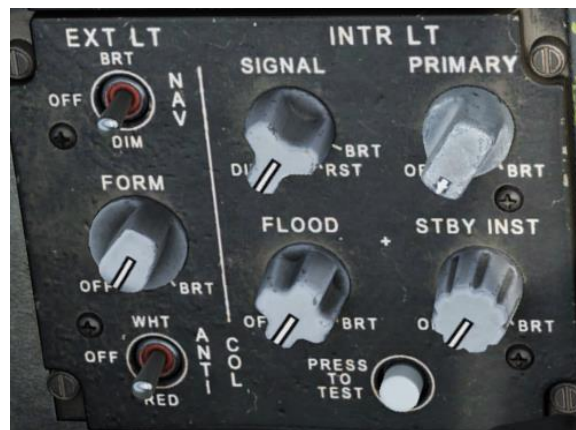
图 30. 外部/内部灯光面板
