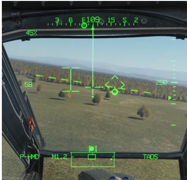
图 247. 使用 HMD 进行火箭弹攻击 - 向“工”字符号的位置转向
