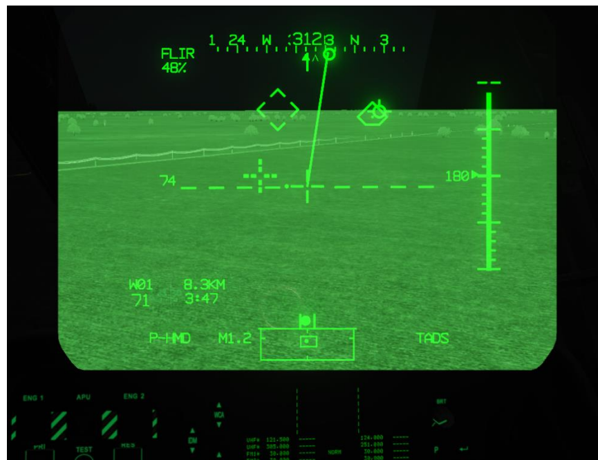
图 208. 带飞行符号和飞行员夜视系统传感器图像的飞行员头盔显示装置
