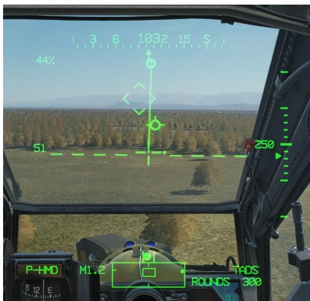
图 225. HMD 机炮攻击 - HMD 瞄准视线十字准星对准目标
