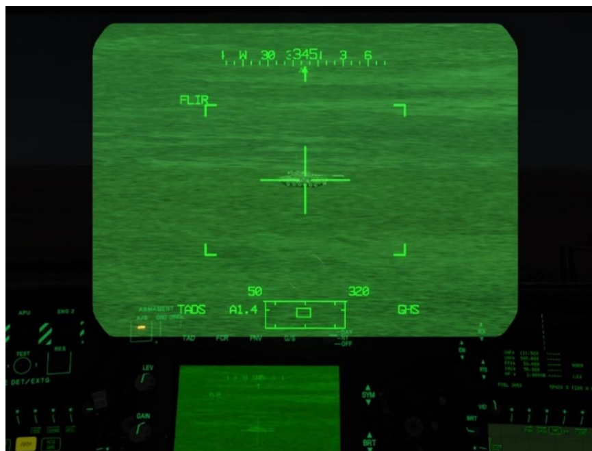
图 209. 显示有武器标记和 TADS 传感器图像的副驾驶头盔显示装置
